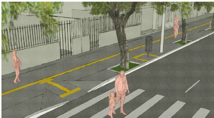
PERSPECTIVA COM EXEMPLO DE CALÇADA ACESSÍVEL
